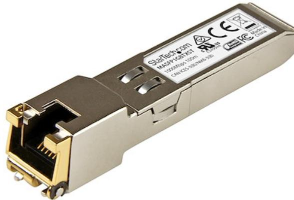
Il prodotto MASFP1GBSXST è un modulo ricetrasmittitore in rame compatibile con Cisco Meraki MA-SFP-1GB-SX, progettato, programmato e testato per operare con switch e router a marchio Cisco Meraki™. Offre un'affidabile connettività da 1 GbE (1000 Mbps) tramite cablaggi in rame per le reti compatibili 10BASE-T, 1000BASE-T e 100BASE-TX, a una distanza massima di 100 m.
