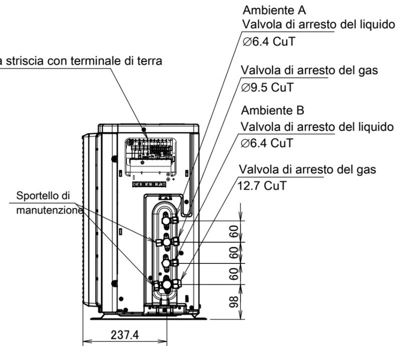
In caso di rimozione della copertura della valvola di arresto.
