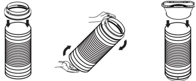
Agganciare il raccordo con il prodotto ad una delle estremità del tubo estensibile. Capovolgere il tubo estensibile ed agganciare il raccordo per il kit finestra fornito a corredo.
