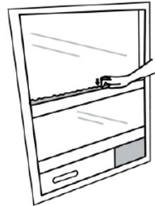
4 Inserire ulteriore sigillante nelle aree rimaste aperte per completare la sigillatura.
