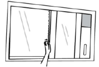
4 Inserire ulteriore sigillante nelle aree rimaste aperte per completare la sigillatura.
