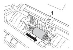
6 L'alloggiamento del rullo di prelevamento presenta un'apertura stretta, progettata per evitare la caduta del rullo; la forma dell'asse del rullo di prelevamento corrisponde a tale apertura. Ruotare il rullo di prelevamento fino a quando la forma dell'albero non corrisponde all'apertura dell'alloggiamento.
