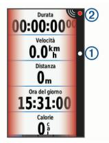
Il LED di posizione del veicolo ① si illumina mano a mano che un veicolo si avvicina alla bici. Il LED del livello di pericolo ② cambia colore in base al potenziale livello di pericolo. Il verde indica nessun veicolo è rilevato. Ambra indica un veicolo in avvicinamento. Rosso indica che un veicolo sta avanzando ad alta velocità.
