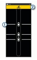
La posizione del veicolo ① si sposta sullo schermo mano a mano che un veicolo si avvicina alla bici. Il banner del livello di pericolo ② cambia colore in base al potenziale livello di pericolo. Il verde indica nessun veicolo è rilevato. Ambra indica un veicolo in avvicinamento. Rosso indica che un veicolo sta avanzando ad alta velocità.
