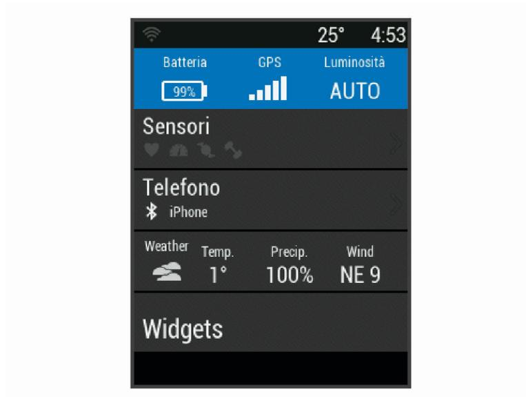
Viene visualizzata la pagina di stato. Un'icona lampeggiante indica che il dispositivo sta cercando un segnale. Un'icona fissa indica che il segnale è stato trovato o che il sensore è connesso.
