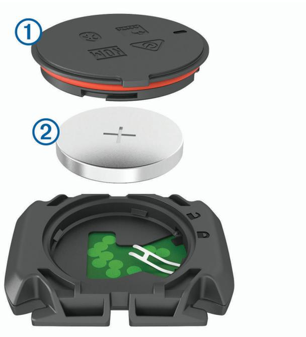
2 Ruotare il coperchio in senso antiorario finché gli indicatori non indicano lo sblocco e il coperchio non è sufficientemente allentato per rimuoverlo.
