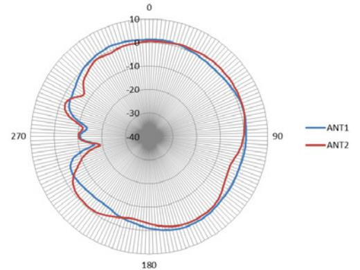
5 GHz montaggio a soffitto
