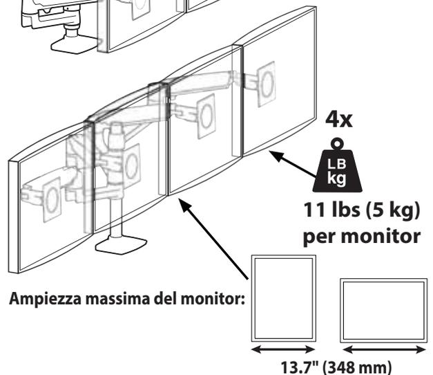
L'ampiezza massima del monitor diminuirà in funzione della configurazione del braccio.
