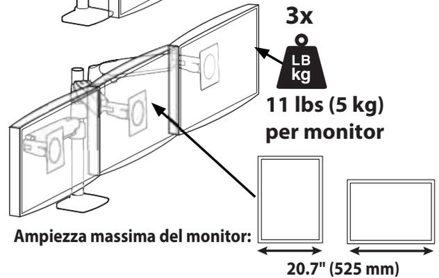
L'ampiezza massima del monitor diminuirà in funzione della configurazione del braccio.
