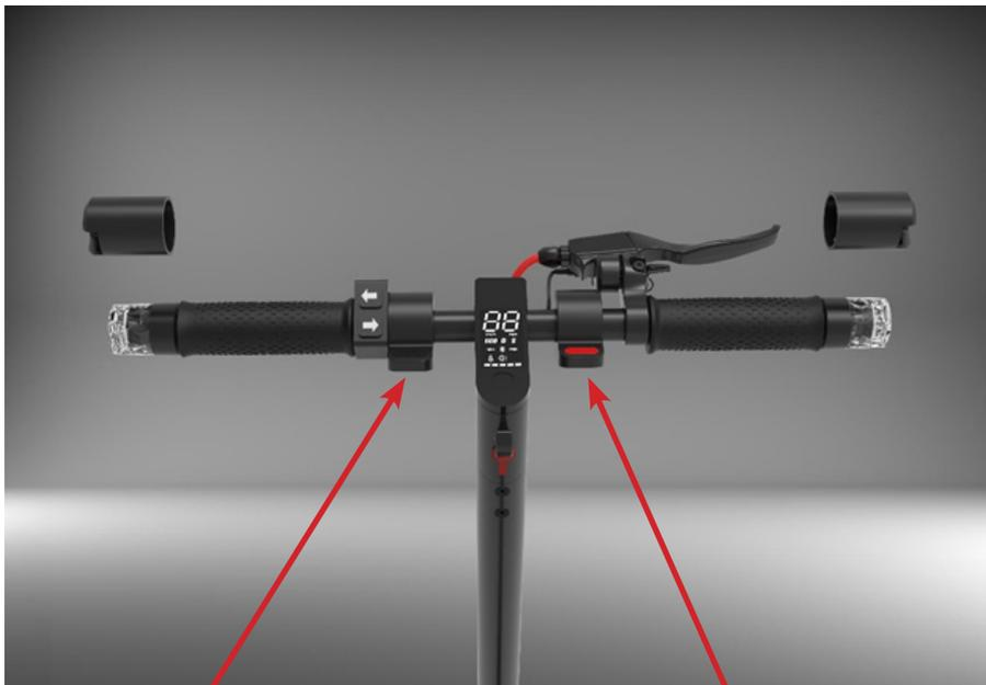
Controllo del freno elettronico anteriore e il controllo delle frecce.
