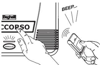
Il dispositivo emette una segnalazione acustica intermittente, il Led ROSSO lampeggia, e inizia a chiamare uno ad uno i numeri di telefono impostati, alternando le chiamate ai numeri fino a 10 volte ognuno.
