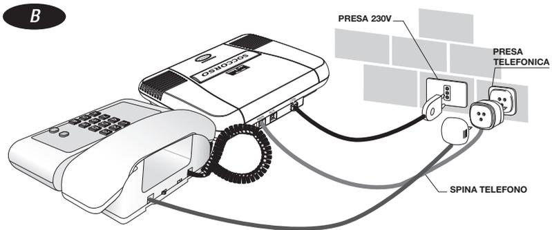
Qualora l'impianto telefonico esistente non fosse dotato di presa telefonica standard, collegate il dispositivo come indicato in figura.
