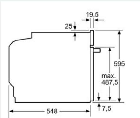
Montaggio con un piano di cottura.
