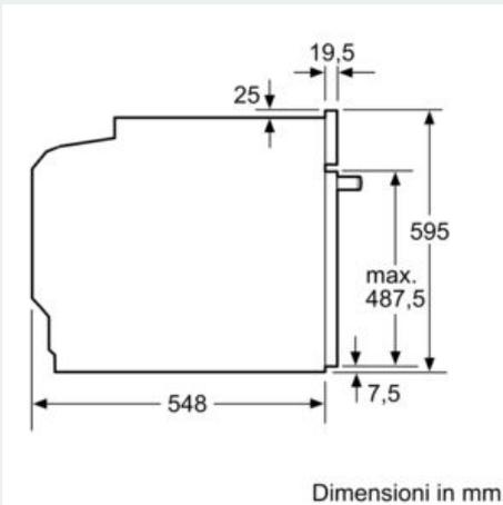
Montaggio con un piano di cottura.
