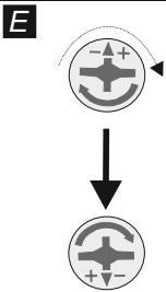
Ruotare gli eccentrici (21) posizionati sui fianchi e sulla tramezza, in senso orario in modo da fissare il coperchio ai fianchi. Fissare la base (7) ed il tirante (9) al fianco dx (2) con la vite 7x50 (26).
