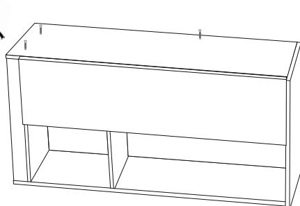
Girare il mobile sull'altro fianco fissare l'anta dx (4) come descritto al punto G. Fissare la base (7) ed il tirante (9) al fianco sx (3) con la vite 7x50 (26).
