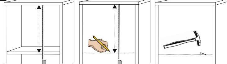
Per una migliore adesione della schiena si consiglia di fissarla alle tramezze (5): posizionare in piedi il mobile e, dalla parte anteriore, prendere le misure interne dal coperchio al centro delle tramezze; sul retro del mobile, con le misure prese precedentemente, partendo dall'alto da sotto il coperchio segnare due linee sulla schiena; piantare infine i chiodini (16) equidistanti sulle linee.
