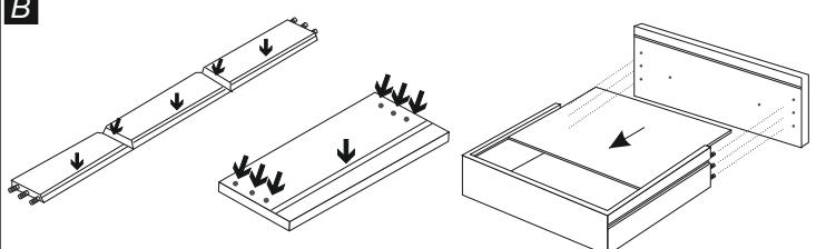
Appicare la colla su sponda (13) e davanti cassetto (12) nei punti indicati utilizzando la colla (20) in dotazione. Chiudere la sponda sul fondo cassetto (14) con il lato colorato rivolto verso l'interno del cassetto, ed inserire i fianchi della sponda nel davanti cassetto.
