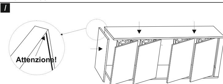
Inserire sopra il fianco dx (2) sul telaio così ottenuto, sempre inserendo i rispettivi perni sui fori posti sulle sponde. Chiudere il tutto con il coperchio (1), infilandolo lateralmente sui due fianchi con i perni per eccentrico (22) inseriti precedentemente.
