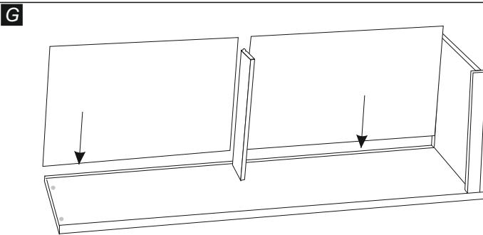
Aprire le schiene (10 e 11) facendo attenzione a non forzare la pellicola di giunzione. Infilare ora le schiene facendole scorrere nelle apposite guide poste su base (8) e tramezza (7).
