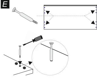
Avvitare i perni per eccentrico (22) nei fori sul coperchio (1). Avvitarli sino a fine corsa. Aprire completamente una guida (17) ed fissarla con 2 viti 3,5x16 (29) sul fianco sx (3) usando come riferimento i fori presenti sul fianco stesso. Ripetere l'operazione sul fianco dx (2).
