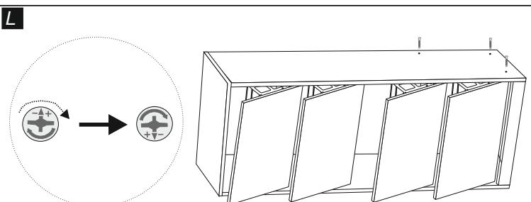
Ruotare gli eccentrici (23) posizionati sui fianchi in senso orario in modo da fissare il coperchio ai fianchi. Fissare la base (8) e la tramezza (7) al fianco dx (2) con le viti 7x50 (32). Coprire gli eccentrici (23) e le viti 7x50 (32) rispettivamente con gli appositi tappini (24 e 28).
