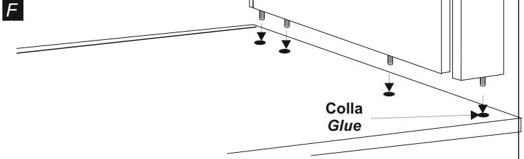
Sul fianco sx (3) inserire negli appositi fori, la base (8), la tramezza (7). Mettere un poco di colla ed inserire lo zoccolo (9). Prima di inserire il fianco dx (2), inserire un poco di colla nel foro per lo zoccolo.
