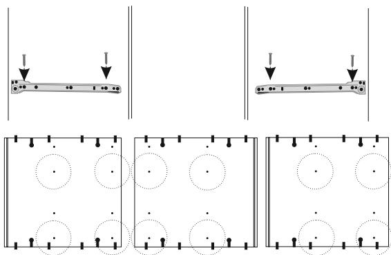
Fissare le guide cassetto (17) sui fianchi dx e sx (2,3) con le viti 6,3x13 (18), e sulla tramezza (5) con le viti 6,3x9 (19).
