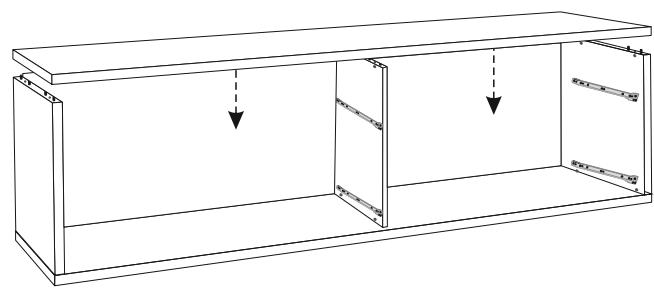
Chiudere il telaio così ottenuto con il coperchio (1) infilandolo nei rispettivi fori posti sui fianchi e tramezza con i perni per eccentrico (24).
