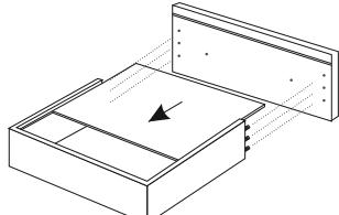
Distendere su un piano il davanti cassetto (11) e la sponda cassetto (12), ed applicare la colla (29). Chiudere la sponda sul fondo cassetto (10) con il lato colorato verso l'interno del cassetto, ed inserire i fianchi della sponda nel davanti.
