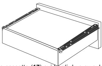
Capovolgere il cassetto e fissare le guide cassetto (17) sui bordi dx e sx sul fondo del cassetto con le viti 3,5x20 (19). Le guide vanno poste con le ruote rivolte verso l'esterno e retro del cassetto.
