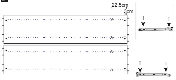
Fissare sul fianco sx (3) le guide cassetto (17) con le viti 6,3x13 (18). Fix on the Lh side (3) the drawer runners (17) with the screw 6,3x13 (18).
