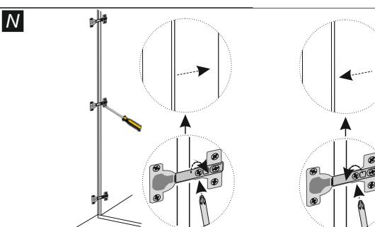
Se l'apertura/chiusura delle ante non è perfetta, è necessario agire con il cacciavite sulla vite posta al centro delle cerniere, avvitando e/o svitando leggermente. In relazione al senso di rotazione della vite sulla cerniera, l'anta si avvicina o allontana dal fianco del mobile.
