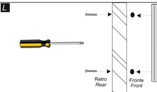
Montare le maniglie (15) su ante e cassetti utilizzando le viti 4x20 (16). Tenere la maniglia in corrispondenza dei rispettivi fori sulla parte esterna dell'anta ed inserire le viti nei fori posti all'interno, quindi fissare la maniglia avvitando con il cacciavite.
