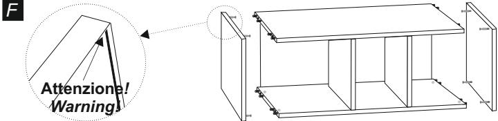
Inserire ora il fianco dx (2) sulla struttura facendo attenzione a far combaciare la guida del fianco alla schiena ed i perni sul fianco ai fori sul bordo delle tramezze (5). Inserire ora gli eccentrici sui restanti fori delle tramezze e fissarli come al punto E. Inserire il coperchio (1) e la base (4) infilandoli lateralmente sui due fianchi con i perni per eccentrico (27). Quindi fissarli come descritto al punto E.
