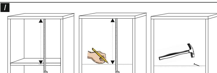
Per una migliore adesione della schiena si consiglia di fissarla alla tramezze (5): posizionare in piedi il mobile e, dalla parte anteriore, prendere le misure interne dal coperchio al centro delle tramezze; sul retro del mobile, con le misure prese precedentemente, partendo dall'alto da sotto il coperchio segnare due linee sulla schiena; piantare infine i chiodini (22) equidistanti sulle linee.
