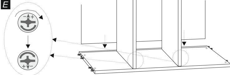
Appoggiare il fianco sx (3) su un piano come da figura ed inserire gli eccentrici 18 (26) nei fori sulle tramezze (5) con la freccia rivolta verso i fori posti sui bordi. Inserire quindi le tramezze (5) sul fianco. Ruotare gli eccentrici posizionati sulle tramezze (5) in senso orario in modo da fissarle. Inserire la schiena pieghevole (6) sul fianco nell'apposita guida.
