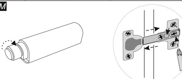
Chiudere le ante e verificare che tutti i frontali siano allineati. Eventualmente agire sui push-pull, avvitando o svitando il supporto per regolarne l'apertura. Per spostare le ante verso l'esterno o l'interno del mobile, allentare gire sulla vite indicata in figura e spostare leggermente la cerniera verso l'interno o l'esterno.
