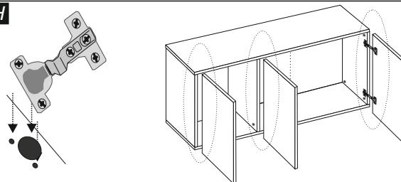
Fissare le cerniere a collo alto (13) su 2 ante (5). Fissare le cerniere a collo dritto (12) sulla restante anta (5). Posizionare quindi l'anta con le cerniere a collo alto (13) adiacente al fianco e fissare la cerniera nei rispettivi fori posti sul fianco. Ripetere l'operazione con l'altra anta con la cerniera a collo alto (13) sull'altro fianco. Fissare ora l'anta con le cerniere a collo dritto (12) alla tramezza (4).
