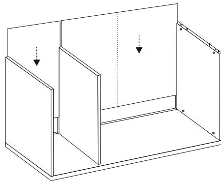
Inserire la schiena (6) e la schiena pieghevole (7) con il lato colorato rivolto verso l'interno del mobile, facendole scorrere nelle guide poste sui fianchi e sulla tramezza.
