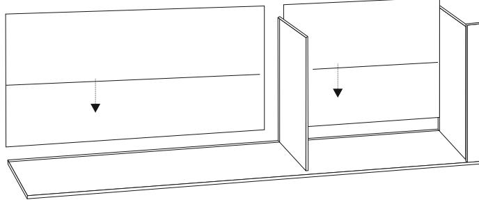
Aprire le schiene (8 e 9) facendo attenzione a non forzare la pellicola di giunzione. Infilare ora le schiene facendole scorrere nelle apposite guide poste su base (5) e tramezza (7).
