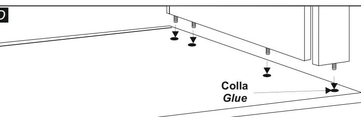
Sul fianco sx (3) inserire negli appositi fori, la base (5) e la tramezza (7). Mettere un poco di colla ed inserire lo zoccolo (6). Prima di inserire il fianco dx (2), inserire un poco di colla nel foro per lo zoccolo.
