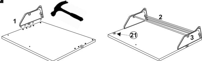
Per tutte le ante (4): appoggiare l'anta su una superficie piana, inserire una sponda (10) negli appositi fori sull'anta utilizzando un martello. Infilare le 3 canne (11) nei fori sulle sponde ed inserire un'altra sponda sull'anta. Fissare ora la piastrina (21) all'anta con la vite 3x12 (22).
