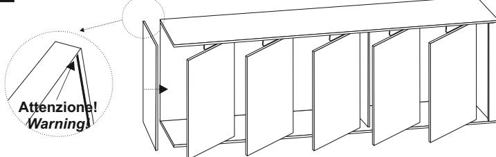
Inserire sopra il fianco dx (2) sul telaio così ottenuto, sempre inserendo i rispettivi perni sui fori posti sulle sponde. Chiudere il tutto con il coperchio (1), infilandolo lateralmente sui due fianchi con i perni per eccentrico (16).
