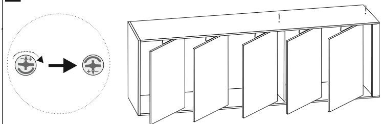
Fissare ora il coperchio ruotando gli eccentrici (14) sui fianchi e coprirli con i tappini (15). Fissare il fianco con le viti 7x50 (24) e coprirli con i tappini (23). Ruotare il mobile e ripetere l'operazione sull'altro fianco. Fissare ora i piedini (12) negli appositi fori posti sulla base del mobile.
