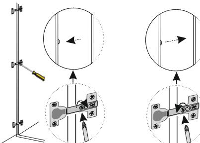
Se l'apertura/chiusura delle ante non è perfetta, è necessario agire con il cacciavite sulla vite posta al centro delle cerniere, avvitando e/o svitando leggermente. In relazione al senso di rotazione della vite sulla cerniera, l'anta si avvicina o allontana dal fianco del mobile.
