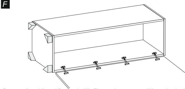
Ruotare il mobile sul fianco dx (2). Fissare la tramezza (6) con la vite 7x50 (19). Posizionare l'anta (4) adiacente al fianco dx (2) con i fori delle cerniere ai rispettivi fori sul fianco. Inserire le cerniere (9) nei fori posti sull'anta e sul fianco ed avvitare come mostrato in figura.
