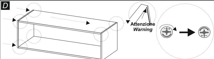
Inserire sopra il fianco dx (2) sul telaio così ottenuto, facendo scorrere la schiena sulla guida posta sul fianco ed il perno della tramezza (6), inserendolo nei rispettivi perni posti sulla base. Chiudere il tutto con il coperchio (1), infilandolo sui due fianchi con i perni per eccentrico (14). **Attenzione: non rompere i bordi alle estremità della fresata sulla base.** Ruotare in senso orario gli eccentrici (15) posti sui fianchi. Coprire gli eccentrici (15) con i tappini (16).
