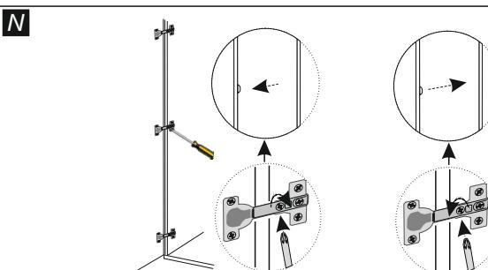
Se l'apertura/chiusura delle ante non è perfetta, è necessario agire con il cacciavite sulla vite posta al centro delle cerniere, avvitando e/o svitando leggermente. In relazione al senso di rotazione della vite sulla cerniera, l'anta si avvicina o allontana dal fianco del mobile.
