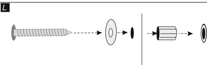
Riposizionare il mobile adiacente alla parete ed, internamente all'anta, inserire la vite (13-b) nella rondella (13-c), e l'insieme nel foro sulla schiena, quindi sul retro, inserire la vite nel distanziale (13-d) ed inserirlo nel foro sul muro (stessa operazione con l'altro foro). Quindi fissare le viti alla parete. **Attenzione: trattenere il mobile durante questa operazione onde evitarne la caduta.**
