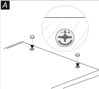
Inserire gli eccentrici (15) nei fori (in alto ed in basso) posti sui fianchi dx e sx (2 e 3). Avvitare i perni per eccentrico (14) nei fori sul coperchio (1) e sulla base (5). Avitarli sino a fine corsa.
