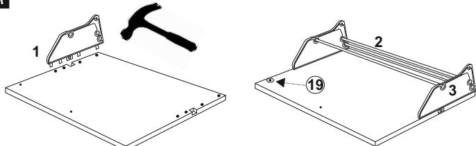
Per tutte le ante (4): appoggiare l'anta su una superficie piana, inserire una sponda (8) negli appositi fori sull'anta utilizzando un martello. Infilare le 3 canne (9) nei fori sulle sponde ed inserire un'altra sponda sull'anta. Fissare ora la piastrina (19) all'anta con la vite 3x12 (20).
