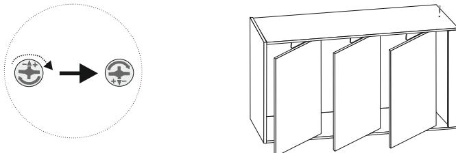
Fissare ora il coperchio ruotando gli eccentrici (12) sui fianchi e coprirli con i tappini (13). Fissare il fianco con le viti 7x50 (22) e coprirli con i tappini (21). Ruotare il mobile e ripetere l'operazione sull'altro fianco. Fissare ora i piedini (10) negli appositi fori posti sulla base del mobile.
