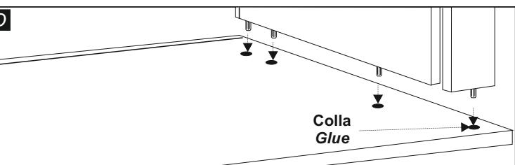
Sul fianco sx (3) inserire negli appositi fori, la base (5). Mettere un poco di colla ed inserire lo zoccolo (6). Prima di inserire il fianco dx (2), inserire un poco di colla nel foro per lo zoccolo.
