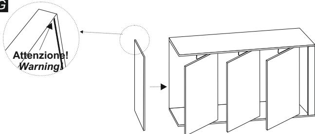
Inserire sopra il fianco dx (2) sul telaio così ottenuto, sempre inserendo i rispettivi perni sui fori posti sulle sponde. Chiudere il tutto con il coperchio (1), infilandolo lateralmente sui due fianchi con i perni per eccentrico (14).
