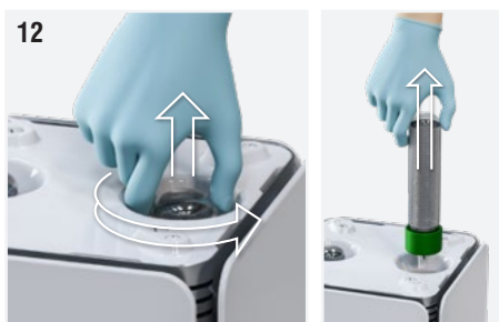
Fig. 12: Svitare delicatamente i tubi ionizzanti agendo sulla superficie di vetro raggiungibile a mano dalle apposite fessure.
