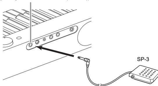
Questo pedale funziona come un pedale damper alle impostazioni iniziali del piano digitale. Per cambiarlo ad una funzione differente (sordina, sostenuto, ecc.), vedere la sezione "Cambio delle funzioni dei pedali" (pagina IT-33).
