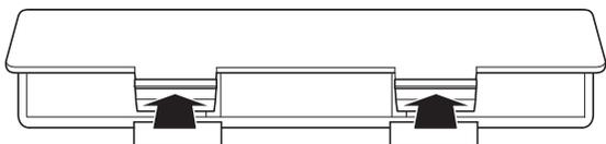
2. Inserire sei pile di formato AA nello scomparto delle pile.
