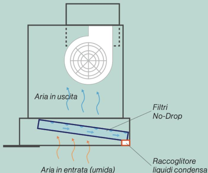
*I vapori condensati scivolano per gravità lungo un canale inclinato che li fa confluire in un collettore di raccolta liquidi, che può essere svuotato e rimosso per la pulizia.*
