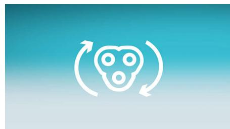
I più recenti rasoi Philips sono dotati di un avviso di sostituzione integrato, rappresentato dal simbolo dell'unità di rasatura, che si illumina quando è necessario sostituire le testine di rasatura.
