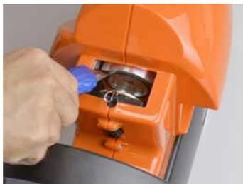
Fig. 6.1-A Estrazione guarnizione
