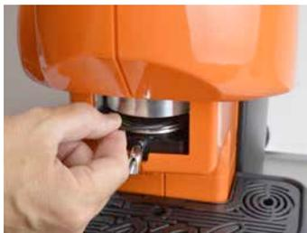
Fig. 6.1-B Prelievo guarnizione
