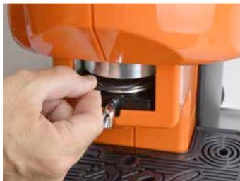
Fig. 6.1-D Inserimento nuova guarnizione
