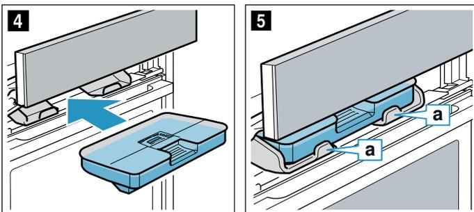
7. Spingere lentamente verso il basso il pannello, poi premerlo all'indietro, fino alla sua completa chiusura. Il serbatoio acqua è pieno. Ora è possibile avviare il funzionamento con il vapore.
