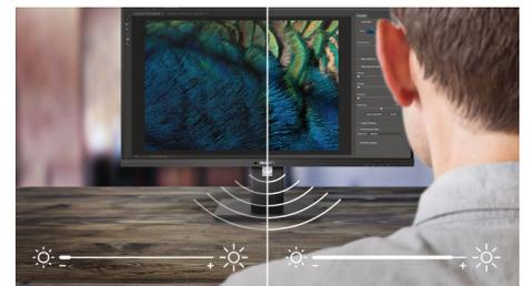
PowerSensor è un sensore integrato che rileva la presenza delle persone. Trasmette e riceve segnali infrarossi non nocivi per determinare l'eventuale presenza di un utente. Se l'utente si allontana dalla scrivania il sensore riduce automaticamente la luminosità dello schermo, tagliando i costi energetici fino al 75% e prolungando la durata di utilizzo dell'apparecchio.
