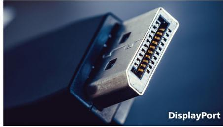
Con l'uscita DisplayPort è possibile collegare più schermi ad alta risoluzione con un solo cavo dal display principale al computer. La possibilità di collegare più display consente di creare un desktop ordinato senza troppi fili.
