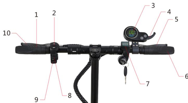
1. Manopola 2. Interruttore Accensione/spengimento fari 3. Display contachilometri 4. Acceleratore 5. Leva freno anteriore 6. Manopola 7. Blocco chiave accensione/spengimento + display visualizzazione tensione batteria 8. Interruttore luci direzione 9. Clacson 10. Leva freno posteriore.
