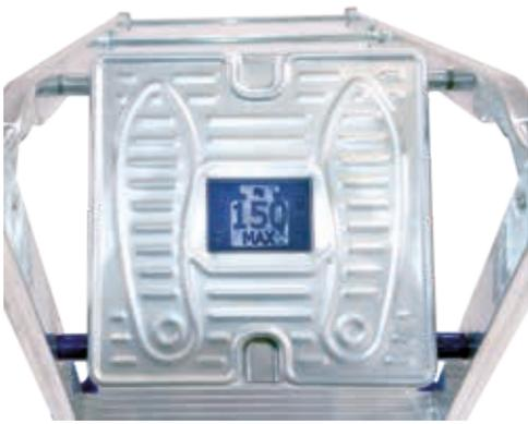
Pedana in acciaio speciale con inserite 50 nervature profonde per ottenere la portata di oltre 260 kg/2700N. (consultare progetto di pagina n.15)
