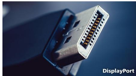
Con l'uscita DisplayPort è possibile collegare più schermi ad alta risoluzione con un solo cavo dal display principale al computer. La
