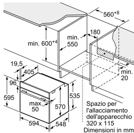
Montaggio con un piano di cottura.
