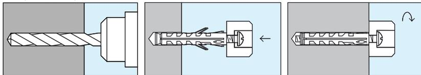
Si raccomanda un'accurata pulizia del foro prima dell'installazione.
