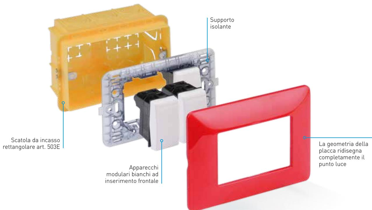
Gli apparecchi sono modulari e sono componibili su supporti a due o tre moduli per installazione, rispettivamente, in scatola rotonda o rettangolare. Il montaggio degli apparecchi sul supporto avviene per semplice pressione, senza l'uso
