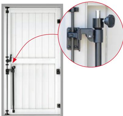
Per installare BLINDY® SBARRA + PARK sullo scuro a tre ante, basta utilizzare i ganci blocca anta (BS110) su tutti i montanti delle ante come mostrato in figura. Basterà poi estendere BLINDY® SBARRA e appoggiarla sui ganci blocca anta ed infine inserirla nei fori del muro.
