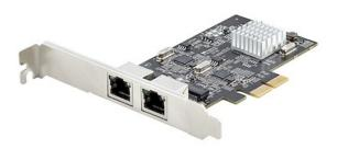
Questa scheda di interfaccia di rete (NIC) a doppia porta da 2,5 GbE è dotata di un chipset Intel I225-V con tecnologia Intel vPro, per migliorare le prestazioni e l'integrità dei dati su due connessioni Ethernet da 2,5G. Le opzioni multispeed variabili (2,5/1Gbps e 100/10Mbps) consentono di supportare sia l'hardware di rete nuovo che quello preesistente. Utilizza l'infrastruttura di cablaggio Cat5e o CAT6 esistente, aggiungendo la compatibilità NBASE-T (802.3bz) per una perfetta integrazione.
