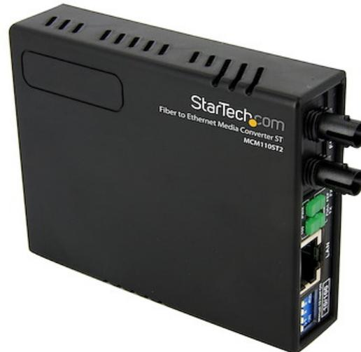
Il convertitore multimediale Ethernet in fibra multimodale ST 10/100 MCM110ST2EU (2 km) crea una conveniente connessione Ethernet-fibra, convertendo in modo trasparente segnali Ethernet da/a 10Base-T o 100Base-Tx e segnali ottici 100Base-Fx per estendere una connessione di rete Ethernet tramite una dorsale in fibra multimodale.
