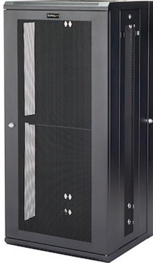
Grazie a questo armadietto rack per server o dispositivi di rete 26U, è possibile montare a parete le apparecchiature conformi alla specifica EIA-310, installandole in un box esterno che offre la massima protezione ed è dotato di uno sportello posteriore a cerniera per un accesso semplificato. La profondità a cui viene installato il box esterno può essere regolata da 7,6 cm a 50 cm, per ottenere una soluzione di stoccaggio affidabile delle apparecchiature montate in rack.
