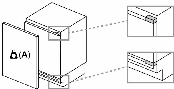
I frontalini montati dell'unità che superano il peso consentito possono causare danni e compromettere il funzionamento delle cerniere
