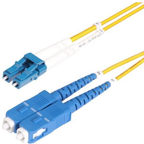
Il cavo patch in fibra ottica OS2 LC a SC Single Mode Duplex facilita la connettività nelle reti 10G. Supporta il Coarse Wavelength Division Multiplexing (CWDM) su una gamma estesa di lunghezze d'onda di 1260-1625 nm, migliorando l'isolamento dei canali per una forza del segnale ottimale su lunghe distanze.
