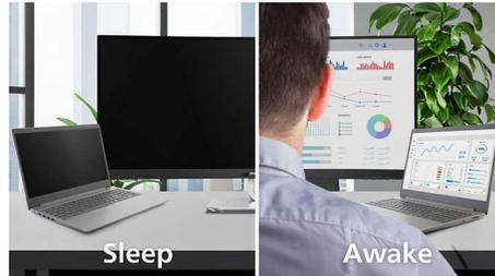
La funzione PowerSensor 2 di questo monitor è in grado di ridurre il consumo energetico rilevando quando gli utenti si avvicinano o si allontanano dallo schermo. Dopo aver impostato l'OSD su "Utente", è necessario regolare le impostazioni di Windows 11 affinché funzioni correttamente. Una volta effettuate le regolazioni, il monitor e il PC/
