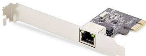
Questa scheda Gigabit Ethernet conforme alle norme TAA aggiunge un'interfaccia Gigabit Ethernet a un desktop o a un server.
