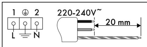
Cavo tripolare 3 x 1,5 mm<sup>2</sup>.
