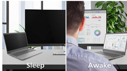
La funzione PowerSensor 2 di questo monitor è in grado di ridurre il consumo energetico rilevando quando gli utenti si avvicinano o si allontanano dallo schermo. Dopo aver impostato l'OSD su "Utente", è necessario regolare le impostazioni di Windows 11 affinché funzioni correttamente. Una volta effettuate le regolazioni, il monitor e il PC/laptop collegati si
