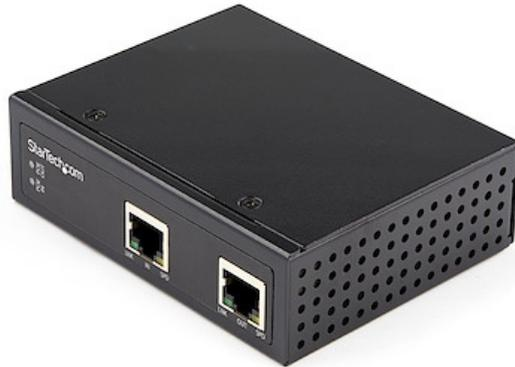
Consente di estendere la portata dei collegamenti PoE fino a 100 m per alimentare dispositivi PD (Powered Device) su lunghe distanze. È possibile collegare a cascata fino a 4 extender per estendere la portata di un dispositivo PSE (sorgente PoE) fino a ulteriori 400 m, per una portata totale di 500 m tra la sorgente PSE originale e il dispositivo di destinazione.
