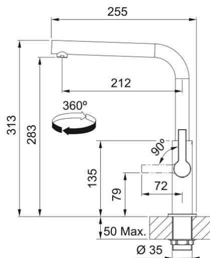
Miscelatore MARIS SLIM L CANNA GIREVOLE CROMATO con rotazione a 360°. E' dotato di LEVA ECO a doppio scatto per la regolazione del flusso di acqua. E' dotato di LEVA ECO a doppio scatto per la regolazione del flusso di acqua
