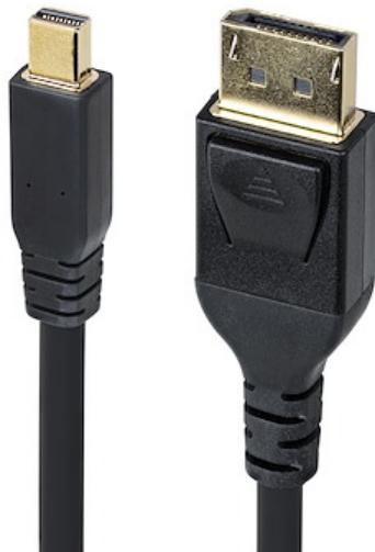
Questo cavo da Mini DisplayPort a DisplayPort v1.4 da 3 metri è dotato di un connettore maschio mDP a un'estremità e di un connettore maschio DP a scatto all'altra, che consente di collegare qualsiasi laptop o workstation con Mini DisplayPort a una TV, un monitor o un proiettore 8K che utilizza una connessione DisplayPort standard.
