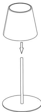
Infine, fissare la testa della lampada avvitandola saldamente sull'ultima colonna.
