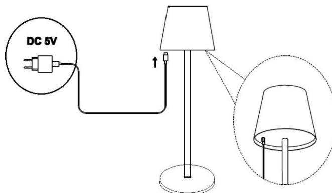
Collegare l'altra estremità del cavo USB a un caricabatterie DC 5V 2A e inserirlo nella presa elettrica.
