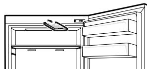
**4** Tenere premuto il pulsante **Freezer** per 3 secondi o più a lungo mantenendo il telefono in prossimità dell'altoparlante fino al completamento del trasferimento dati.
