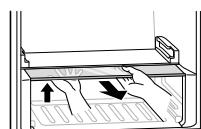
**2** Rimontare il ripiano facendolo scivolare in avanti fino a quando non scatta nel telaio.
